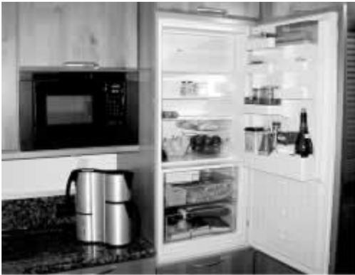
Durch ein geschlossenes Rohrsystem wird ein Kühlmittel gepumpt. Als Pumpe dient ein elektrisch betriebener Kompressor. Über dieses System wird dem Innenraum Energie entzogen und er kühlt ab. An der Rückseite des Kühlschranks wird die dem Innenraum entzogene Energie an die Raumluft abgegeben.
