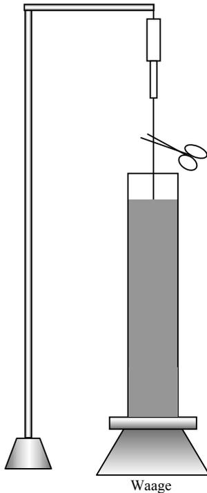
Auf einer Waage steht ein mit Wasser gefüllter Glaszylinder. An einem Kraftmesser hängt ein Metallstück. Mit diesem Aufbau soll experimentiert werden.
