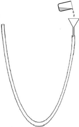
1. Heben Sie ein Schlauchende etwas in die Höhe und beobachten Sie die Wasserstände rechts und links! Wiederholen Sie das Ganze mit beiden Schlauchenden einige Male! Was fällt auf? Notieren Sie ihre Beobachtungen.
