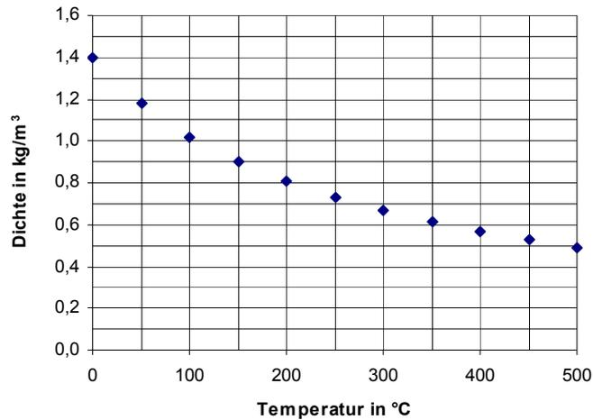
Fahrten mit Heißluftballons werden immer beliebter. Mit einem Gasbrenner wird die Luft im Inneren des Ballons erhitzt. Das Diagramm zeigt den Zusammenhang zwischen der Dichte und der Temperatur der Luft bei konstantem Druck.
