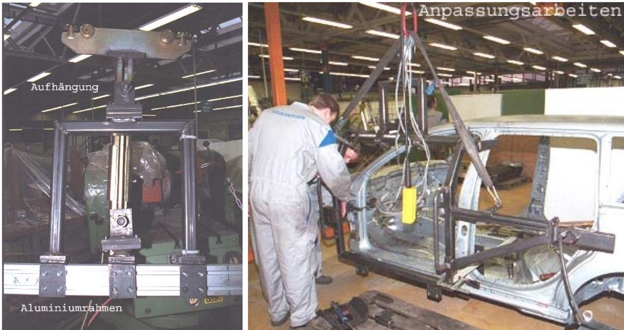
Bau/Entwicklung des Rahmens der Einbauvorrichtung
